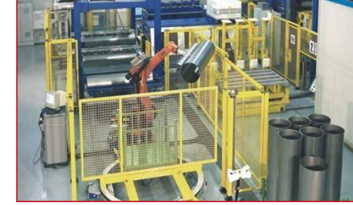
Lazer kaynak tesisleri Son model üretim hattı.
