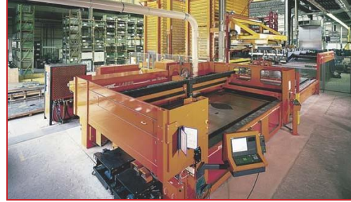
Lazer kesme ekipmanı Hassas tek parça ve küçük çapta üretim.
